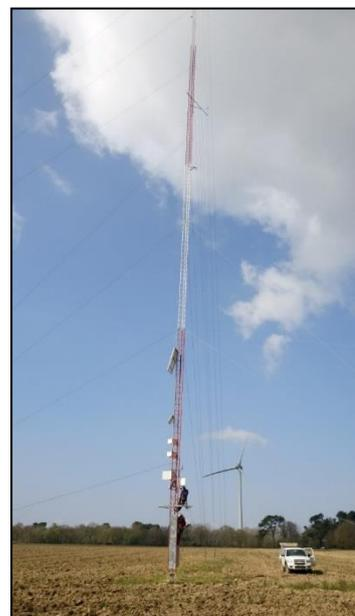
Exemple d'un mât de mesures de vent de 80 m
